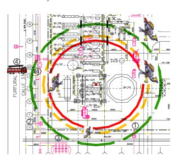
El alcance de la radiación térmica se expresa en círculos concéntricos, con eje en el foco del incendio. La simulación permite trazar 3 círculos, denominados:
