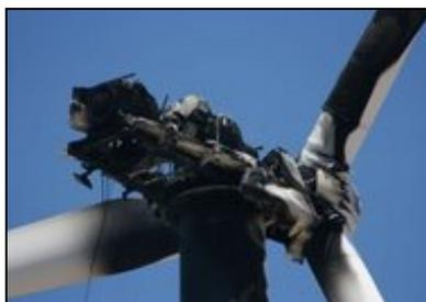
Los daños por fuego son evitados restringiendo la cantidad de material inflamable/combustible en el interior de la cabina, como el material aislante, limitando las Fuentes de ignición, mediante inspección con termografía infrarroja y contando con sistemas de detección e incluso supresión automática en los puntos críticos (subestaciones y transformadores)
